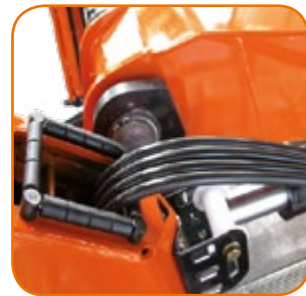
Innenliegende Schlauchführung, guter Schutz für die Schläuche. Internal hose routing, good protection for hoses.
